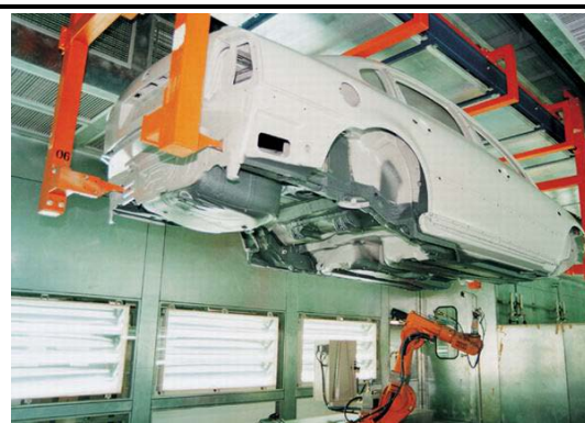
抗石击车底PVC涂胶（参考示意图）
